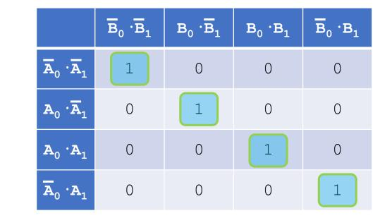
$$EQ = \overline{B}_0 \cdot \overline{B}_1 \cdot \overline{A}_0 \cdot \overline{A}_1 + B_0 \cdot \overline{B}_1 \cdot A_0 \cdot \overline{A}_1 + B_0 \cdot \overline{B}_1 \cdot A_0 \cdot \overline{A}_1 + B_0 \cdot B_1 \cdot \overline{A}_0 \cdot A_1$$
