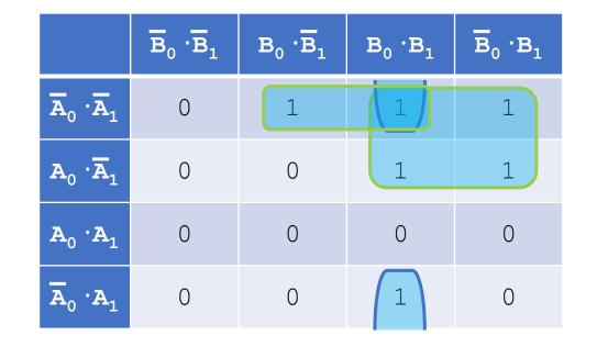
$$LT = B_1 \cdot \overline{A}_1 + B_0 \cdot B_1 \cdot \overline{A}_0 + B_0 \cdot \overline{A}_0 \cdot \overline{A}_1$$
